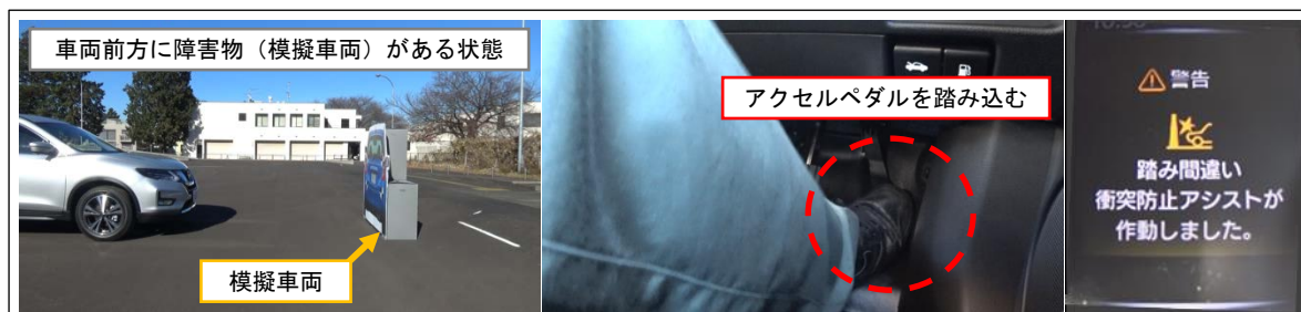
写真2. ペダル踏み間違い時加速抑制装置の動作例（停止状態より）
