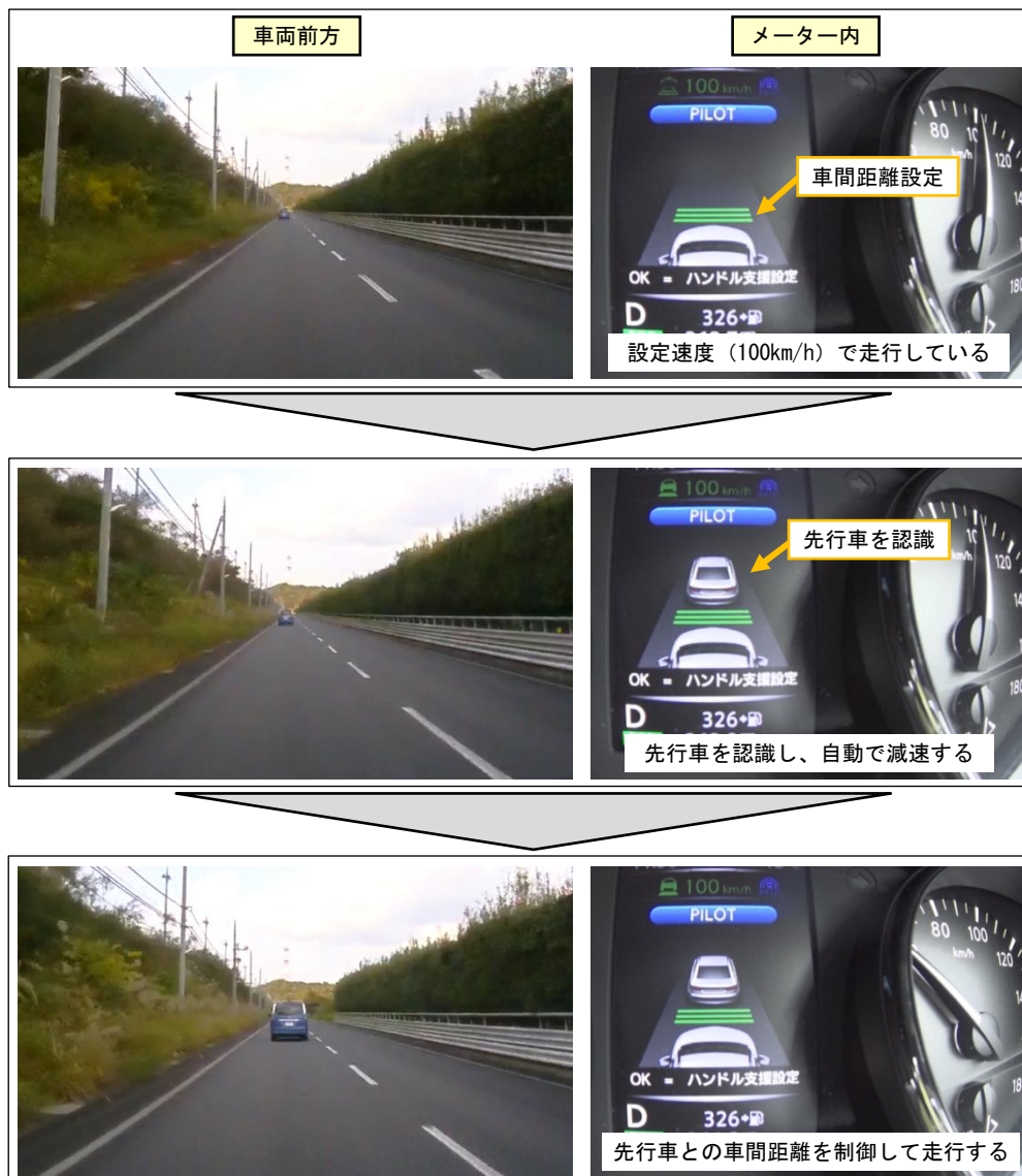
写真 3. 定速走行・車間距離制御装置の動作例（先行車に追従して走行する）
