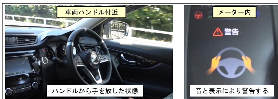
写真 4-2. ハンドル操作をアシストする車線維持支援制御装置の動作例（手放し警告）
